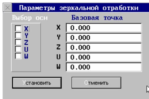
Параметры "Выбор оси" задают отработку программы с зеркальной обработкой заготовки по осям X, Y, Z и др. соответственно (действия аналогичны функции G67 (см. Программирование управляющих программ)). Для включения зеркальности необходимо установить соответствующий элемент кластера и ввести базовую точку.
