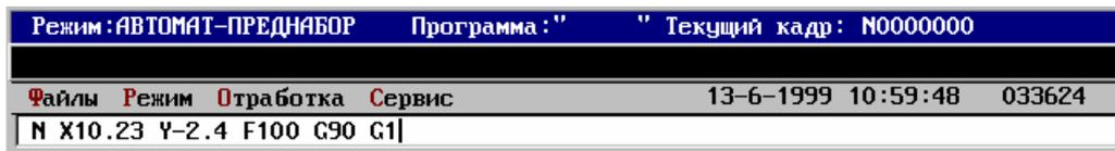
Данный режим предназначен для отработки одного кадра, заданного с клавиатуры компьютера и составленного по правилам программирования.
