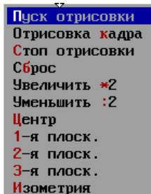
Окно графической отрисовки программ вызывается из главного меню командой "Окна-Графика". Это окно предназначено для прорисовки программ и визуализации процесса обработки. После вызова окна (или после выдачи команды "Сброс") в нем показывается графически абсолютное положение координат (желтым цветом).
