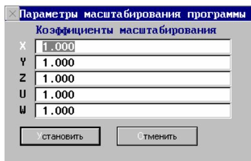
вызывается диалоговое окно настройки подрежима отработки с масштабированием программы. Действия подрежима аналогичны действиям функции G69 (см. Программирование управляющих программ). Для включения подрежима необходимо ввести соответствующие коэффициенты по осям (значение 1 отключает режим масштабирования).
