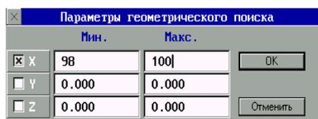
Дальнейшее уточнение условий поиска кадра возможно путем выбора кнопки "Геометрический поиск". При этом будет выполняться поиск не заданного номера кадра, а, например, кадра, в котором задано перемещение по оси X в точку с координатой, находящейся между координа-
