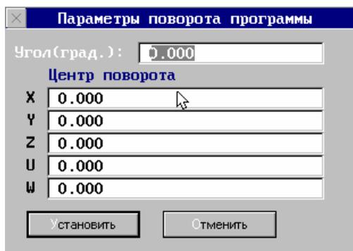
Центр поворота определяется парой координат для соответствующей плоскости. Поворот программы производится только в плоскости, действующей в программе.
